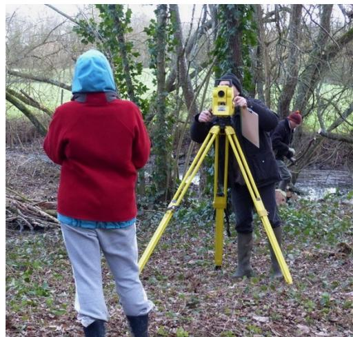
**Le préalable était de dégager les broussailles pour avoir une vision du sol, puis d'effectuer avec un tachéomètre laser et d'une canne à prisme un relevé microtopographique du terrain.**
