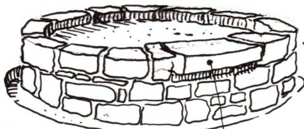
Monter la Maconnerie de pierre de pays, boudée au ciment et à la chaux suivant coupe - prête à recevoir le remplissage (Z) et la dalle Y - poser la Margelle
