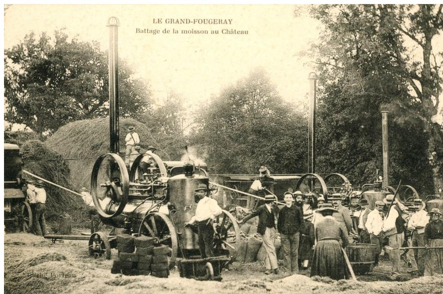
JG : Ensuite, il y a eu les moteurs à essence. Chacun en avait un pour entraîner la batteuse. Il était posé à 5-8 m de la batteuse, à laquelle il était relié par une grosse poulie. Il y a eu aussi les moteurs électriques, quand on a eu l'électricité en 1955. Quand les tracteurs sont arrivés, on les a utilisés pour entraîner la batteuse, toujours par l'intermédiaire d'une poulie.
