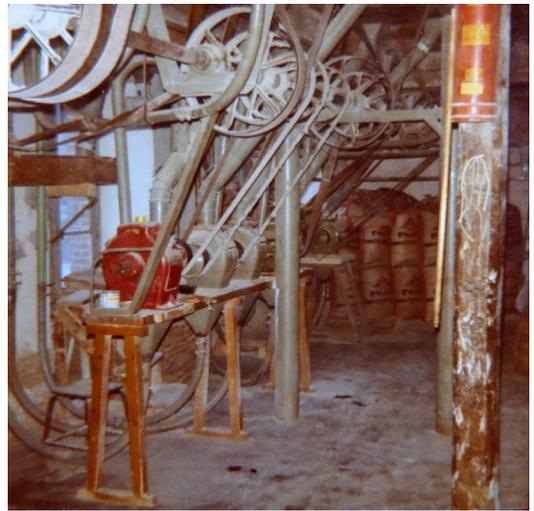
En haut à droite, vers 1970, les « détacheurs », pour séparer la farine de l'enveloppe du grain après l'écrasement dans les cylindres.
