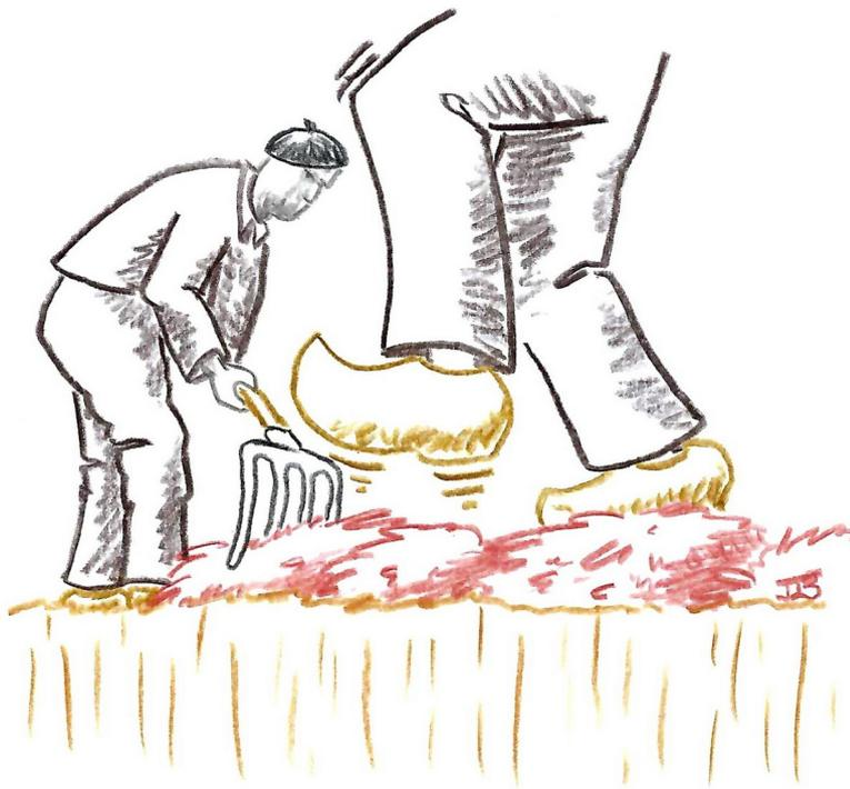
Ensuite, à l'aide d'une fourche à quatre dents, on monte le mélange sur le mur : il faut trois fourchées pour couvrir l'épaisseur du mur, c'est ce qu'on nomme l'assir. On pose une fourchée sur l'intérieur, une sur l'extérieur, une sur le milieu, tout en laissant un débord de 15 cm. Ce débord est ensuite tassé à l'aide d'un gourdin.
