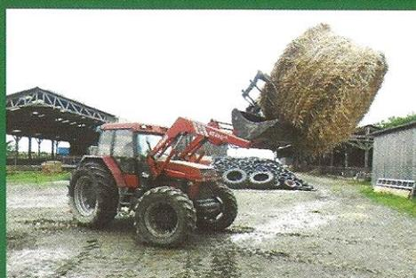
*Bras de levage de l'entreprise MX permettant de soulever des balles de foin de 250 à 300 kgs.*
